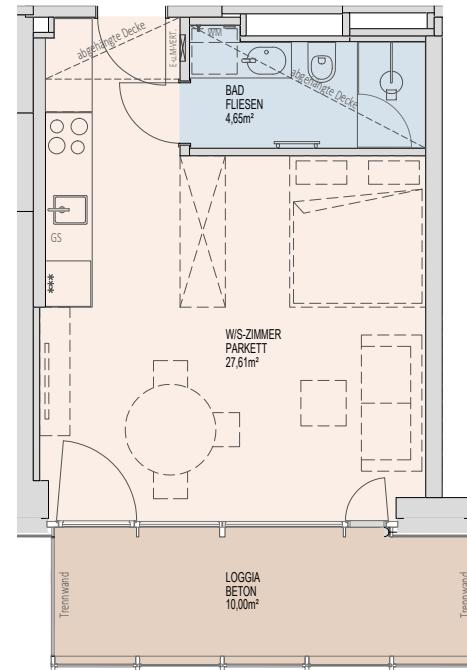
DESER PLAN IST ZUM ANFERTIGEN VON EINBAUMÖBELN NICHT GEEIGNET, DIE DARSTELLUNG IST LEDIGLICH ALS EINRICHTUNGSVORSCHLAG ZU VERSTEHEN. FÜR DIE ANFERTIGUNG VON EINBAUMÖBELN SIND NATURMASSE ZU NEHMEN! EINBAUMÖBEL NICHT AN AUßenWÄNDE STELLEN, DA DIE GEFAHR VON SCHIMMELBILDUNG BESTEHT. DIE KÜCHE IST TEIL DER WOHNUNG, DIESER IST IN DER REGEL MIT OBERSCHRÄKEN AUSGESTATTET. BEI DEN AUFSTELLPLÄTZEN FÜR WASCHMASCHINEN SIND NUR ANSCHLÜSSE VORHANDEN.
